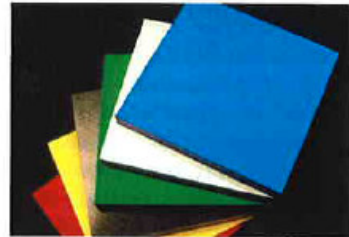
Abb. 3: Farbeloxierte Musterplatten von „Plancast Eloxx 5754“
