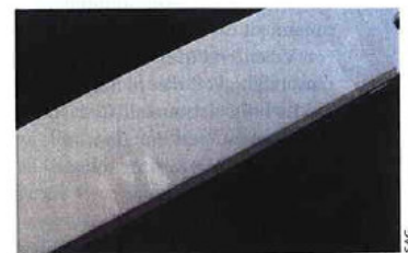
Abb. 1: Materialfehler (Vorerstarungen) einer Knetlegierung 5083, die erst nach dem Eloxieren sichtbar geworden sind
