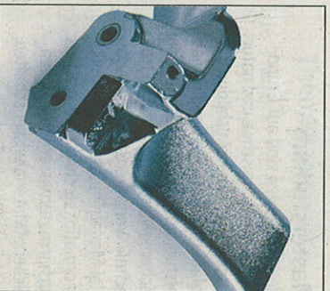
Der Gurtumlenker (u. re.) wird aus einer speziell von SAG entwickelten Legierung im Thixforming-Verfahren hergestellt und im Gurtintegralsitz (li.) für das DaimlerChrysler SL Cabrio eingebaut. Bilder: SMSAG (2)/DAIMLERCHRYSLER
