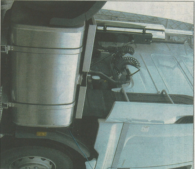
Modernste Aluminium-Technologie von SAG in Lend für die Nutzfahrzeugindustrie: Ein Aluminium-Kraftstofftank bereits auf einem Lkw montiert.
