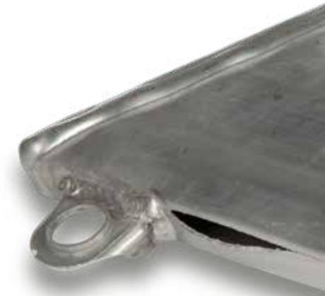
Bersttestergebnis für einen Luftspeicher mit nichtkreisförmigem Querschnitt
