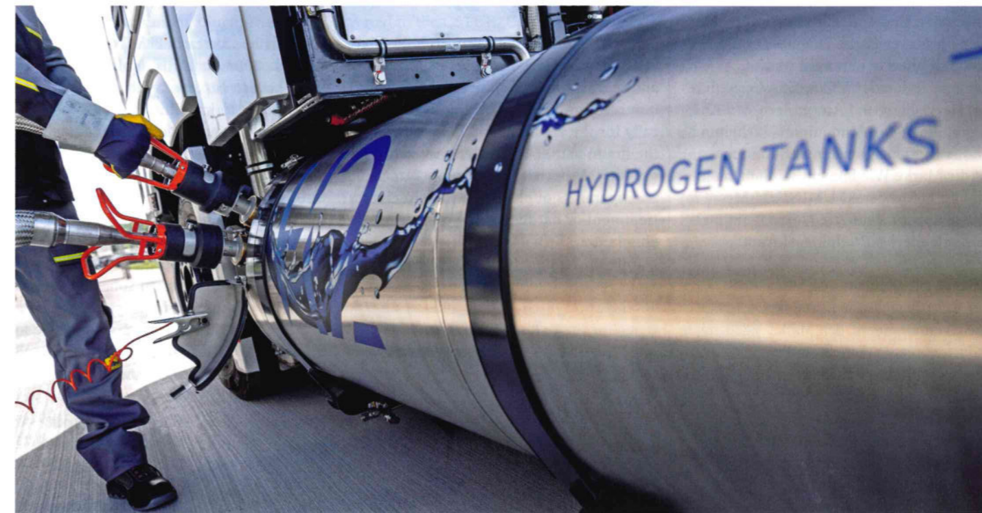
Das LH 2 -Kryotanksystem für flüssigen Wasserstoff ist auf der Teststrecke bei Daimler Truck im Testeinsatz The LH 2 cryo tank system for liquid hydrogen is undergoing testing on the Daimler Truck test track
